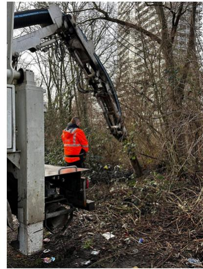
**Schnelle Hilfe:** Saugbagger sind aufgrund ihrer hohen Mobilität perfekt geeignet für technische Hilfeleistungen nach Katastrophen, Havarien, Bränden oder zur Beseitigung von Umweltschäden. In dem Waldstück (!.) wurden Abfälle und auslaufende Ölkübel unsachgemäß entsorgt. Der Saugbagger trägt die Schadstoffe und das verseuchte Erdreich behutsam ab, ohne die tiefer liegende Vegetation und den Wurzelbereich zu beschädigen.
